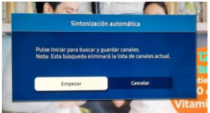
\* Antes de continuar, compruebe si tiene su antena conectada y seleccione "Tipo de canal" : Digital y "Antena" : Aérea (*salvo instalaciones satélite*)
